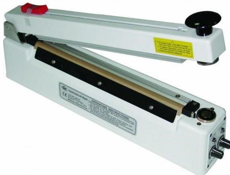
Soudeuses de table à fermeture manuelle et verrouillage électromagnétique. Ces machines sont équipées d'une minuterie de réglage du temps de soudure et d'une minuterie qui contrôle le temps de fermeture, ce qui permet d'optimiser la qualité de la soudure .
