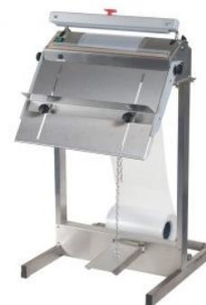
Ces machines industrielles, fiables et robustes, sont particulièrement recommandées pour usage intensif, 3 longueurs de soudure disponibles : 320, 420, ou 620 mm pour souder toutes les dimensions de gaines et de sachets., elles sont équipées d'un couteau permettant la fabrication de sachets et de couper les sur-longueurs des sachets.
