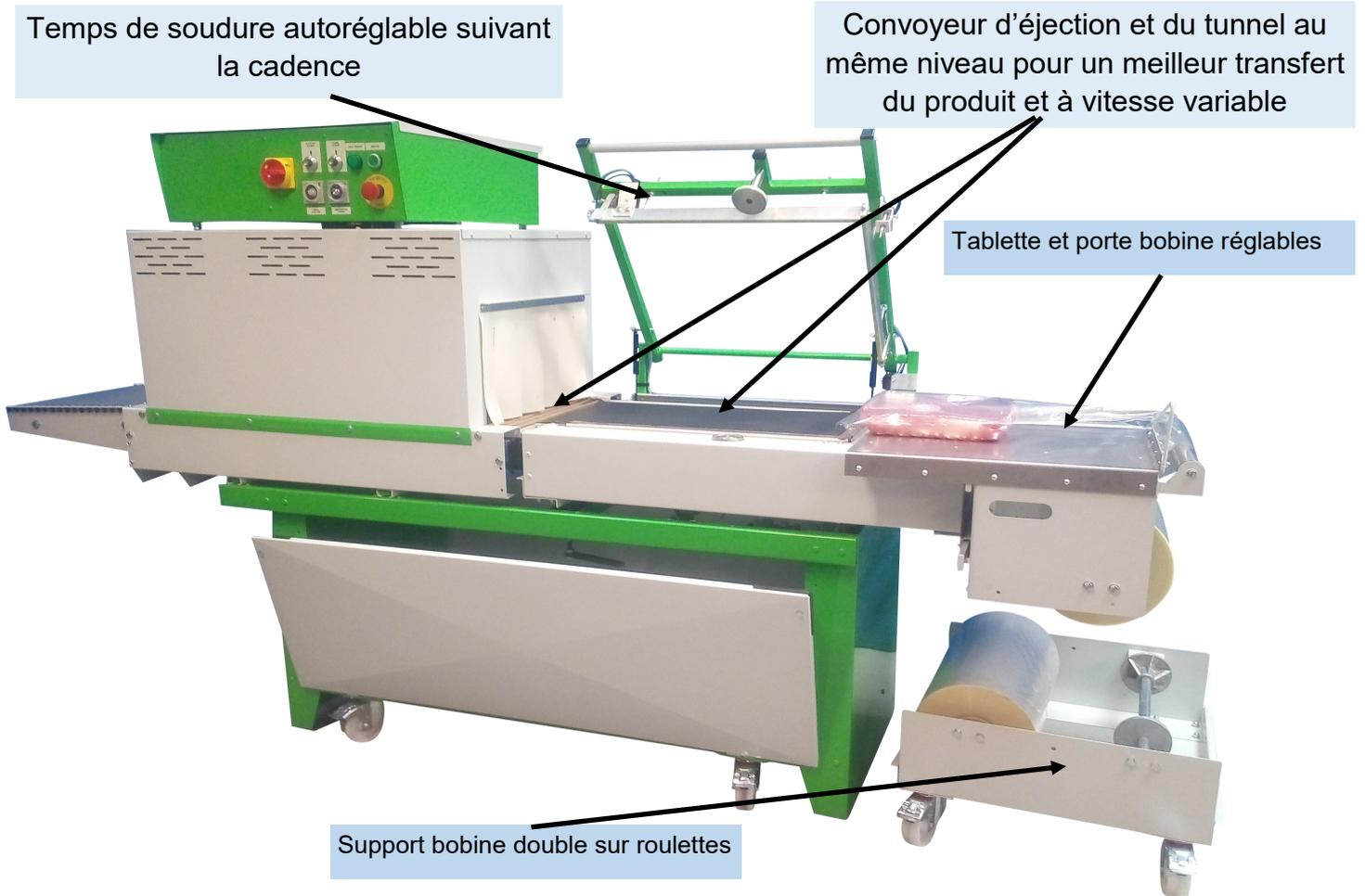
Machine constituée d'une soudeuse en L avec convoyeur d'éjection et d'un tunnel de rétraction montés sur un même bâti avec bac à chutes et roulettes. Elle permet l'emballage avec tous les films thermorétractables de produits divers ( papeterie, imprimerie, industrie du disques, habillement, lots promotionnels etc ) à partir d'un film dossé.
